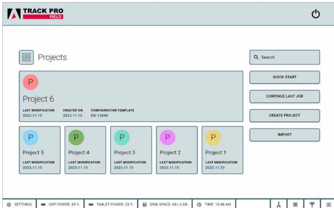
El software Amberg TRACK PRO FIELD es fácil de usar, moderno e intuitivo. Permite al operador reconocer y notificar los defectos de la vía en tiempo real.
