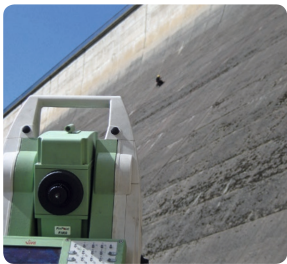
■ Replanteo de puntos en el muro de la presa.
