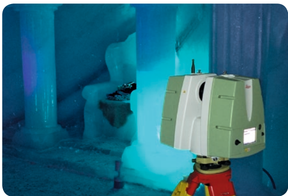
■ ScanStation P20 escaneando el palacio de hielo.
