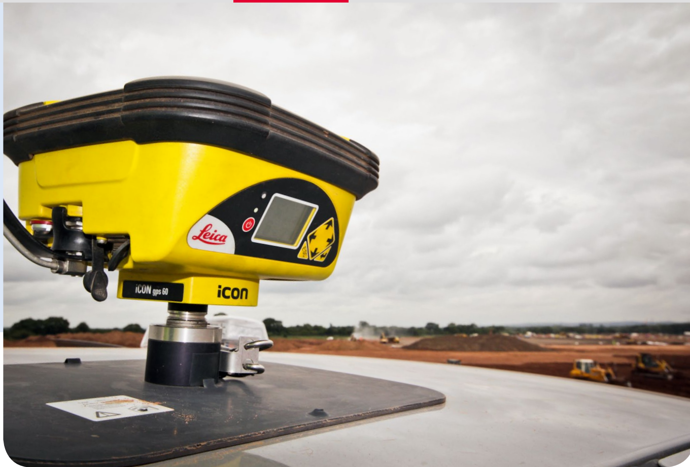
■ Leica iCON gps 60 sobre el techo de la pickup para comprobar alturas en el recinto.
